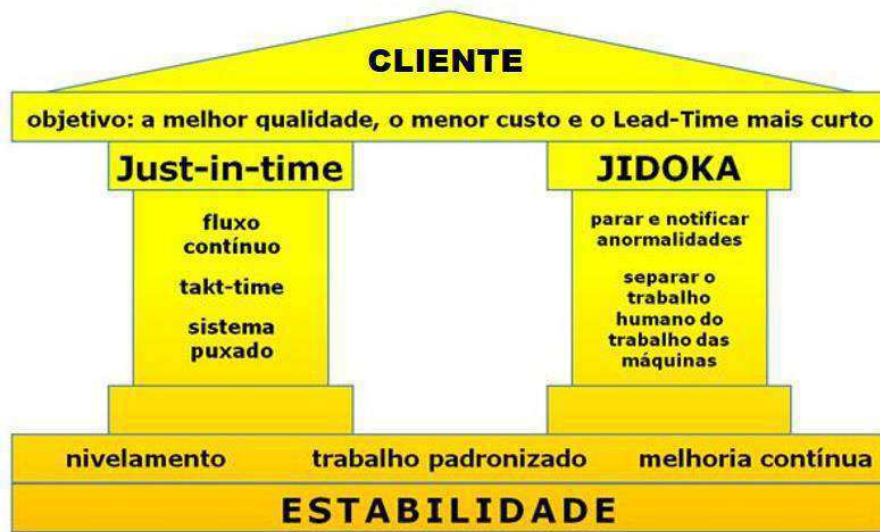
Figura 1 - Estrutura do Sistema Toyota de Produção
