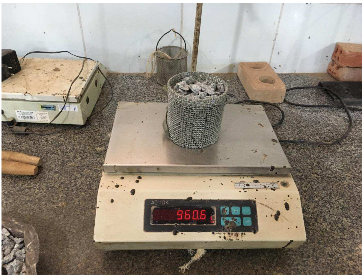
Foto 3 – Ensaio de agregado graúdo no laboratório de concreto da UEMA. (Fonte: acervo do autor )
