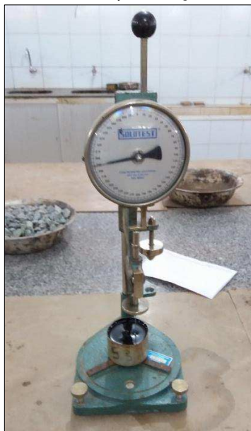
Figura 27 - Ensaio de penetração em execução.
