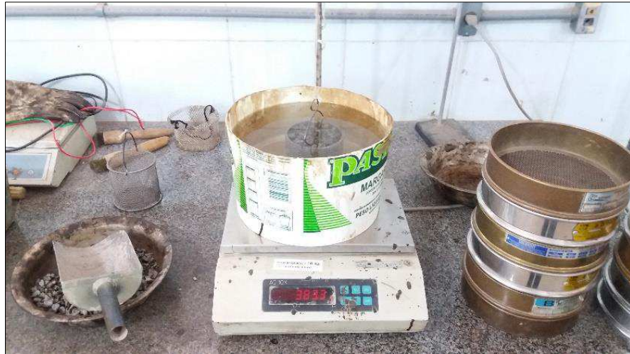
Figura 14 - Pesagem hidrostática do agregado.
