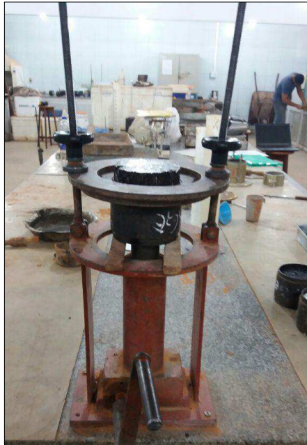
Figura 30 - Desmolde de corpo de prova.
