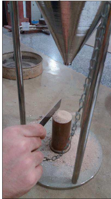
Figura 24 - Ensaio de angularidade em execução.
