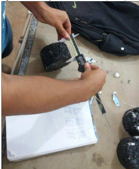
Figura 31 - Medição da altura do corpo de prova.
