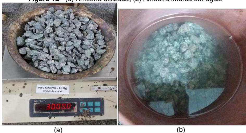
Figura 12 - (a) Amostra utilizada; (b) Amostra imersa em água.
