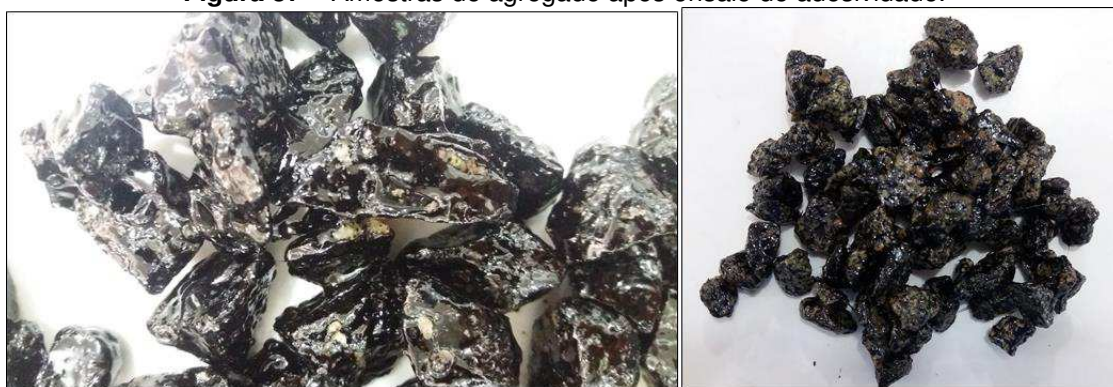
Figura 37 – Amostras de agregado após ensaio de adesividade.
