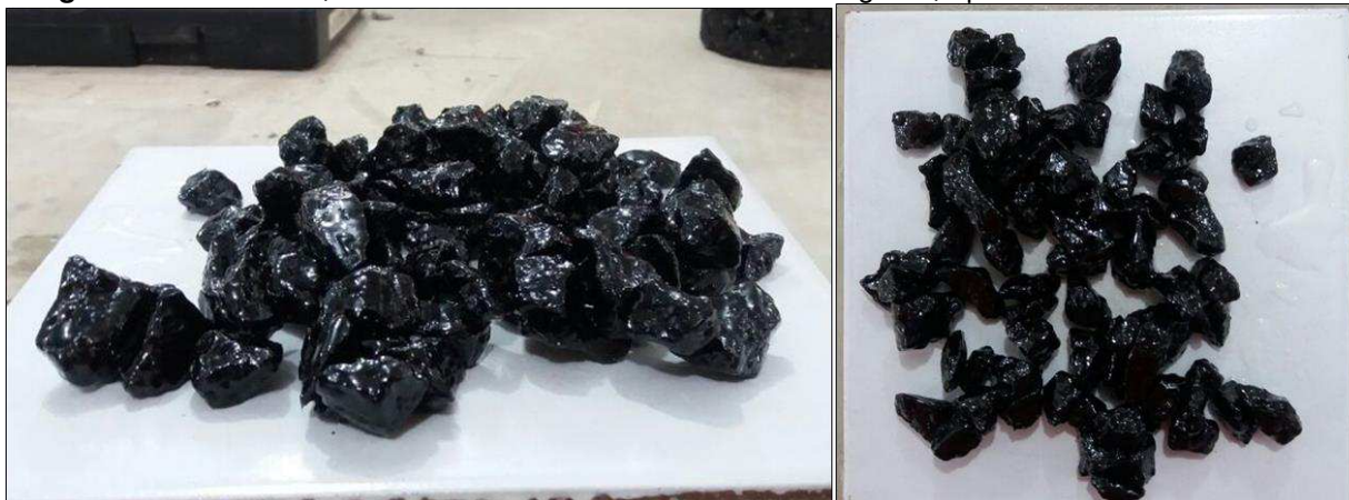
Figura 40 – Amostras, contendo 1% de DOPE adicionado ao ligante, após ensaio de adesividade.
