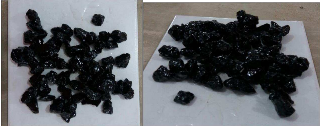
Figura 39 – Amostras, com 1,5% de DOPE adicionado ao ligante, após ensaio de adesividade.
