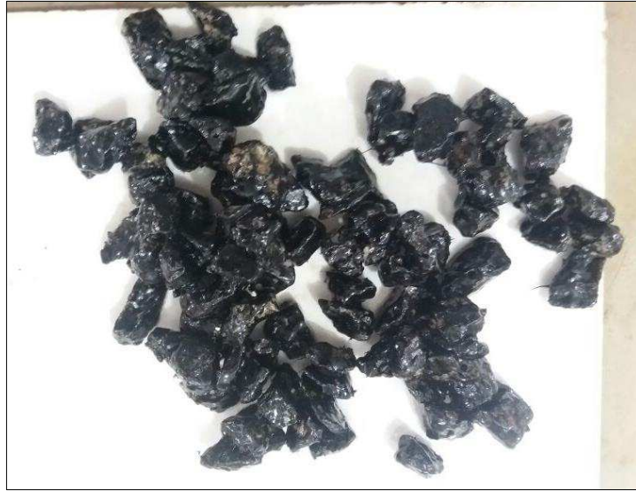
Figura 38 – Amostra de agregado, com 0,5% de DOPE adicionado ao ligante, após ensaio de adesividade.
