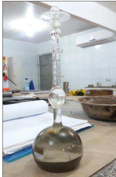
Figura 25 - Frasco Le Chatelier com amostra durante ensaio.
