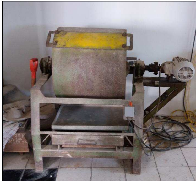
Figura 16 - Máquina "Los Angeles" utilizada para realização do ensaio.
