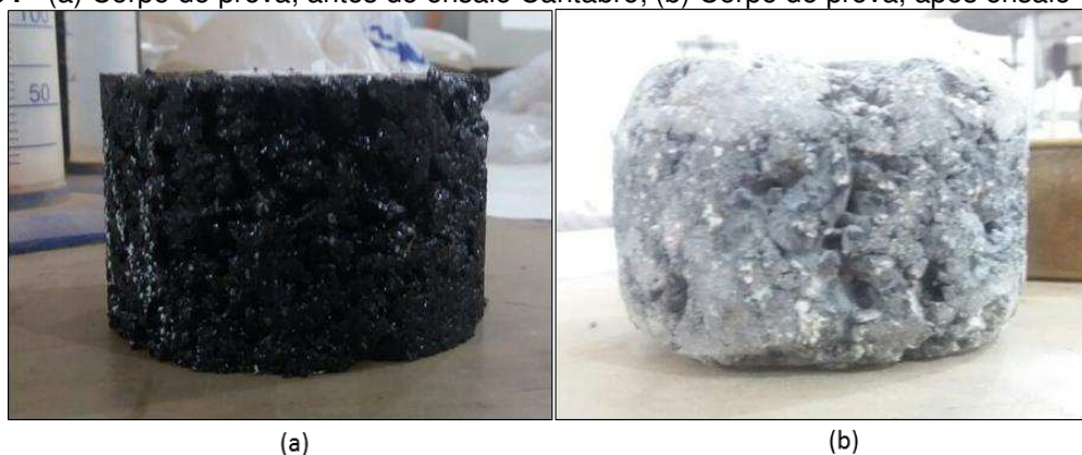
Figura 34 - (a) Corpo de prova, antes do ensaio Cântabro; (b) Corpo de prova, após ensaio Cântabro.
