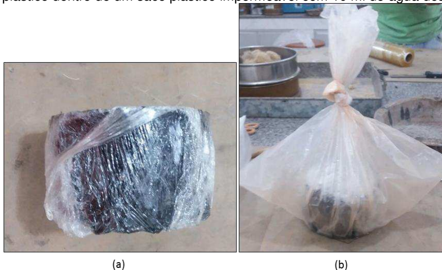
Figura 36 – (a) Corpo de prova embalado em filme plástico; (b) Corpo de prova embalado por um filme plástico dentro de um saco plástico impermeável com 10 ml de água destilada.
