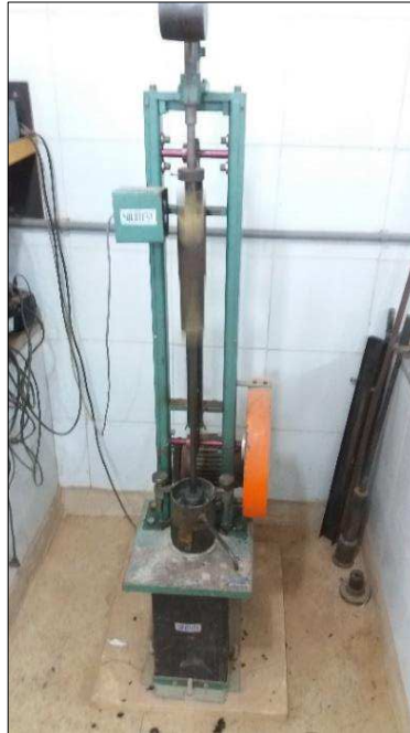
Figura 20 - Compactador Marshall Elétrico utilizado na compactação dos corpos de prova.
