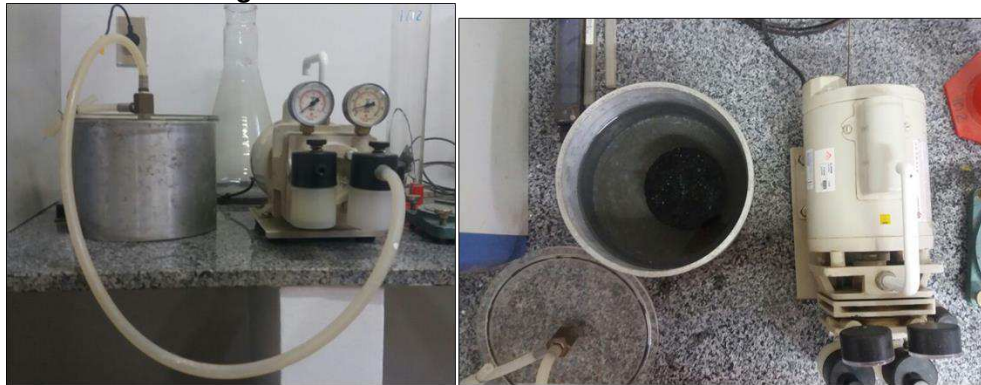
Figura 35 - Bomba de vácuo utilizada durante o ensaio.
