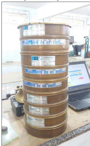
Figura 11 - Sequência de peneiras utilizadas.
