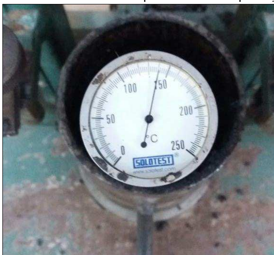
Figura 29 - Termômetro medindo temperatura de compactação da mistura.
