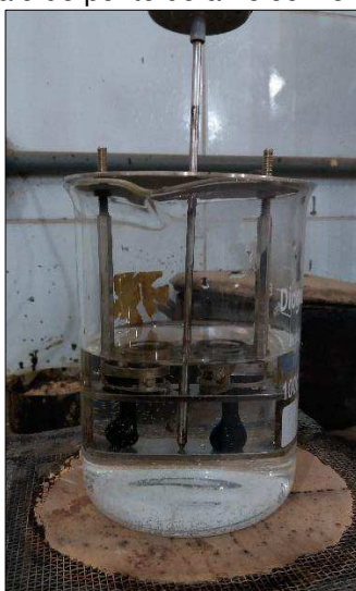
Figura 26 - Ensaio de ponto de amolecimento em execução.
