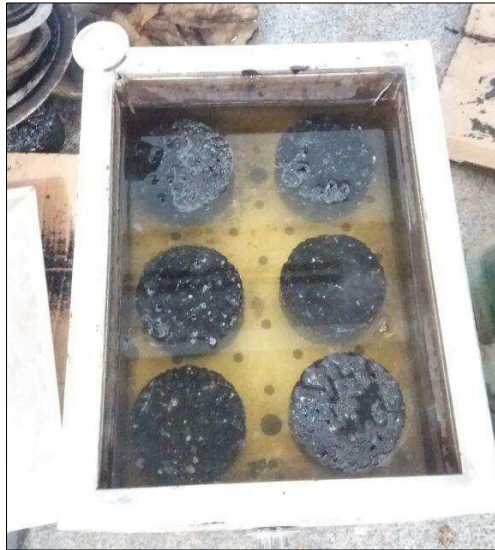
Figura 32 - Corpos de prova no banho-maria a 60 °C.
