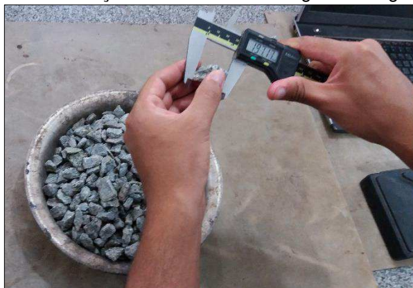
Figura 17 - Medição das dimensões dos grãos de agregado.
