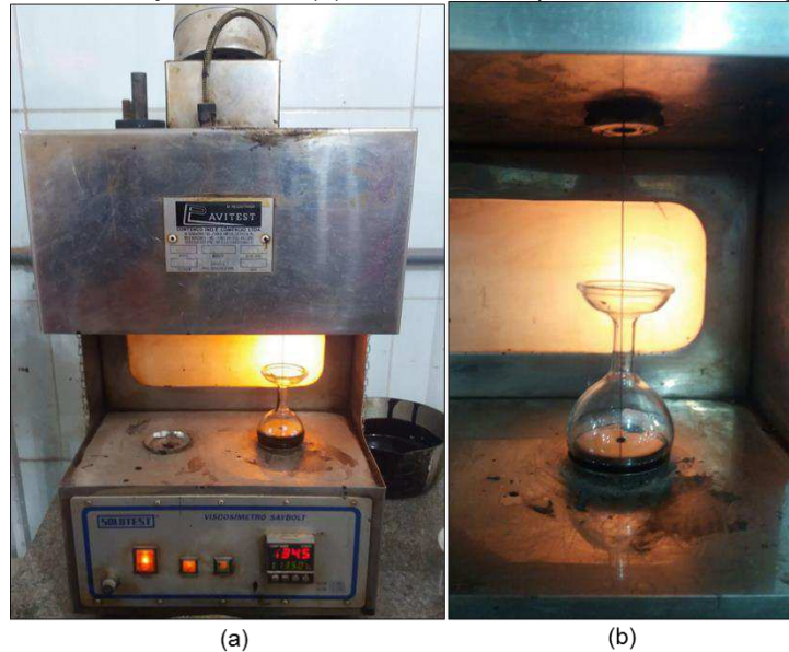
Figura 28 - (a) Viscosímetro Saybolt-Furol; (b) Frasco sendo preenchido com ligante durante ensaio.
