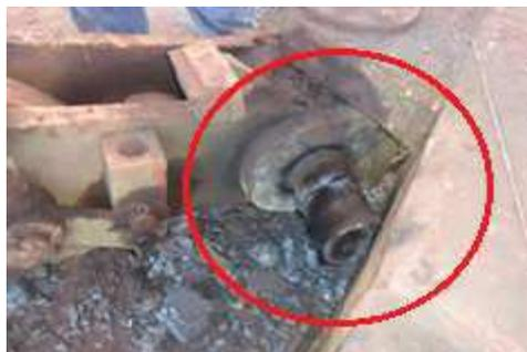
Figura 12 - Perda do pino pela ação do oxiflame
