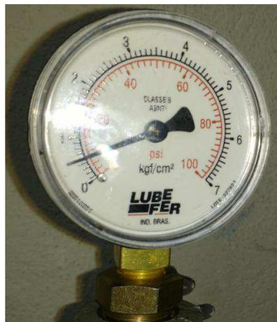
Figura 16 – Manômetro de escala de 0 a 7 kgf/cm<sup>2</sup> (Fonte: Próprio autor).
