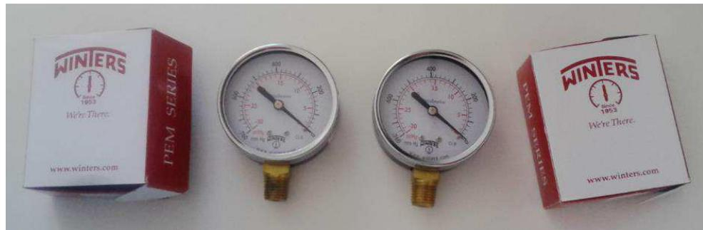
Figura 17 - Vacuômetro de escala de 0 a 760 mmHg (Fonte: Próprio autor).
