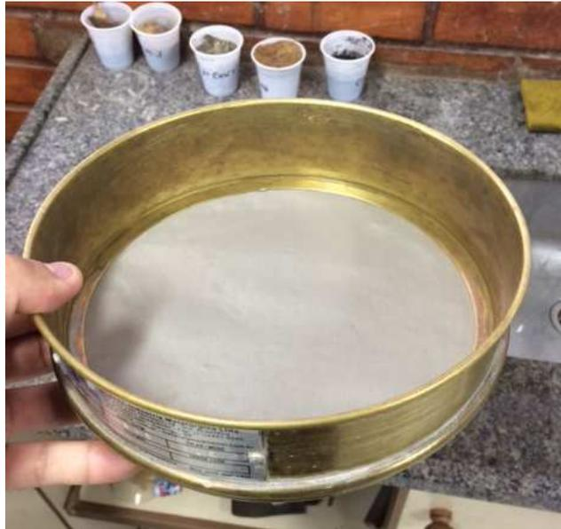
**Figura 5** - Peneira 325, utilizada no ensaio de resíduos.
