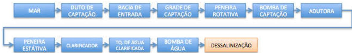
**Figura 2** - Esquema mostrando pré-tratamento da água do mar até o processo de dessalinização por osmose reversa.
