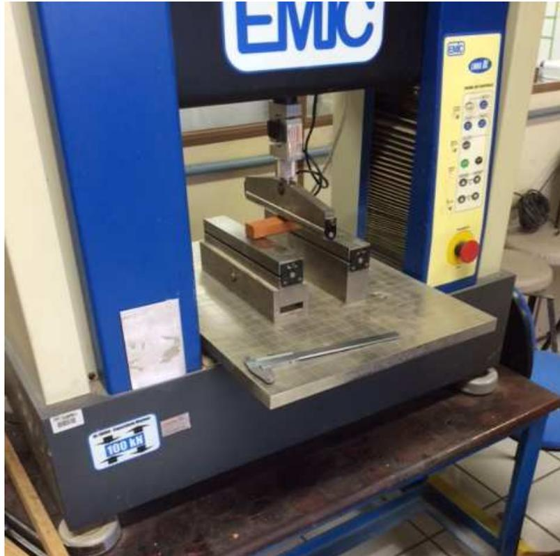
**Figura 8** - Prensa para teste de flexão modelo DL-10000
