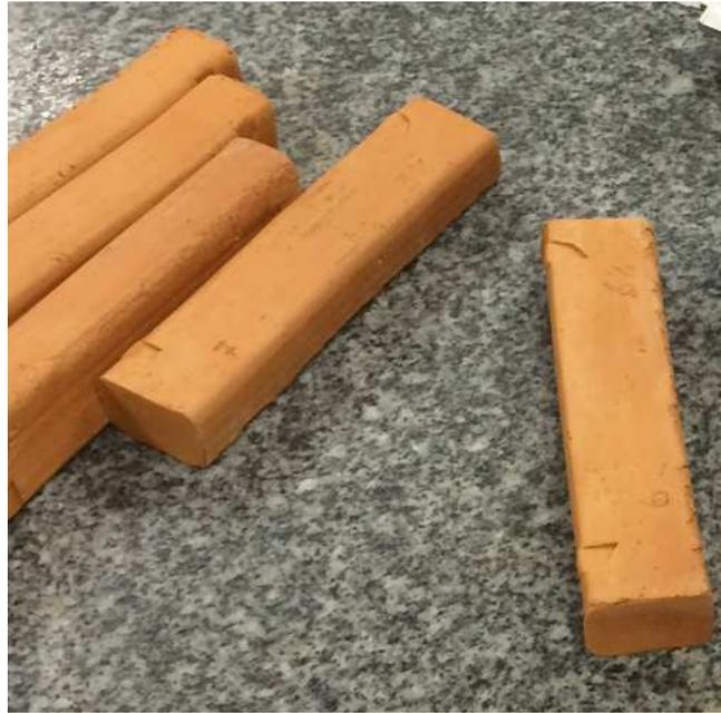
**Figura 7** - Corpos de prova preparados no laboratório do SENAI-MA com a utilização de 3% de lodo
