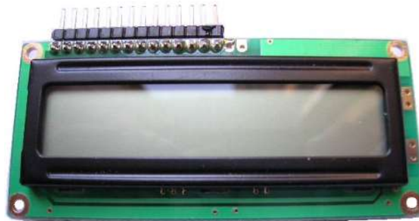
Figura 14 - Visão superior do display LCD 16x1
