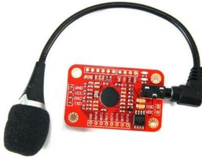
Figura 12 - Visão superior do microfone acoplado ao módulo de reconhecimento de voz
