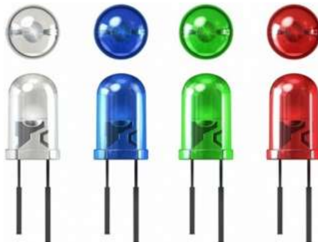
Figura 11 - Visão superior e de perfil dos LED
