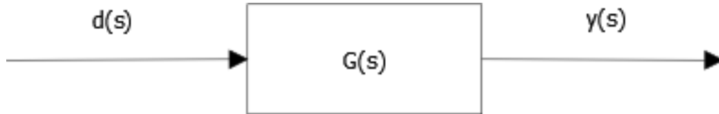
Figura 3.5: Sistema G(s) com entrada d e saída y
