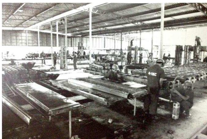
Figura 73: Produção de peças em argamassa armada.
