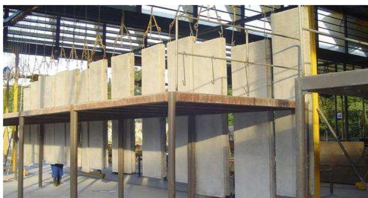
Figura 132: Divisórias em argamassa armada com acabamento uniforme
