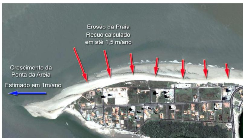
**Figura 16:** Taxas estimativas de erosão e crescimento do pontal arenoso para a situação existente, sem a construção do Espigão.
