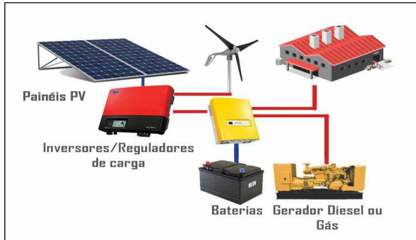
FIGURA 13: SISTEMA FOTOVOLTAICO HIBRIDO
