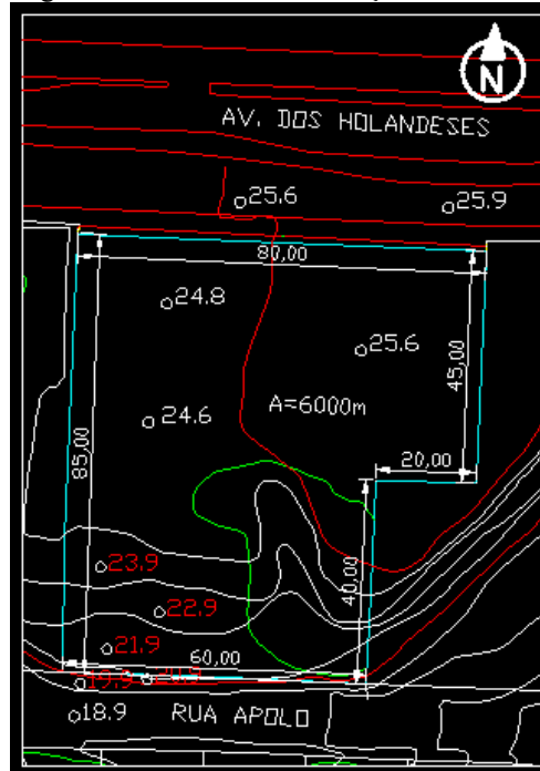
Figura 7 - Terreno com indicação das curvas de nível
