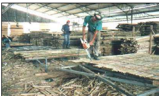
Figura 12 - Aparam-se as arestas das esteiras. (Fonte: Foto de Ana Maria França. Hogar de Cristo, Equador, 2001).
