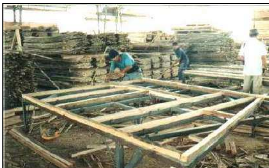
Figura 11 - Produção dos quadros de madeira, a estrutura do painel. (Fonte: Foto de Ana Maria França. Hogar de Cristo, Equador, 2001).
