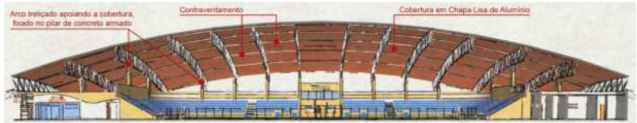
Figura 30 - Corte Longitudinal Ginásio Arco dos Esportes.
