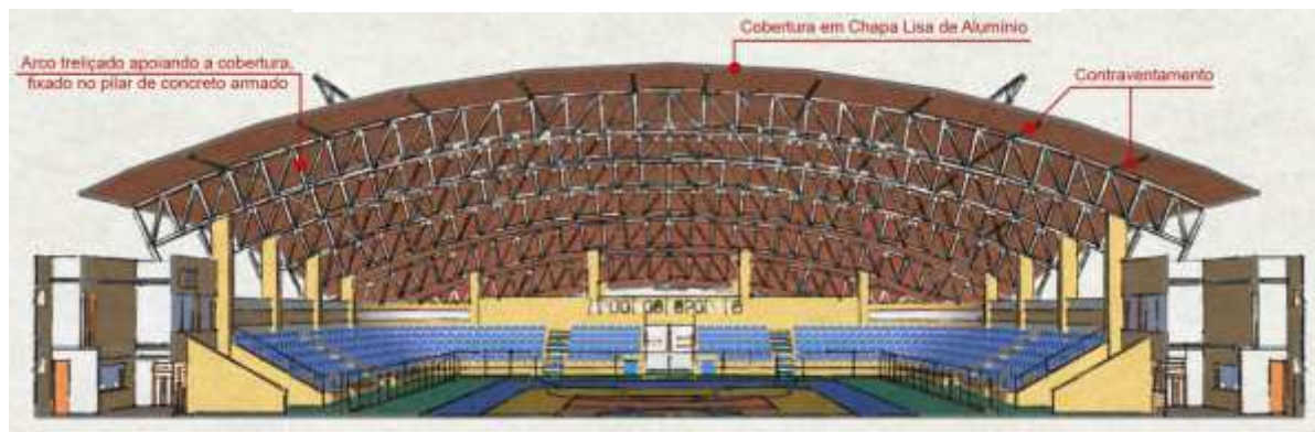
Figura 31 - Corte Transversal Ginásio Arco dos Esportes.
