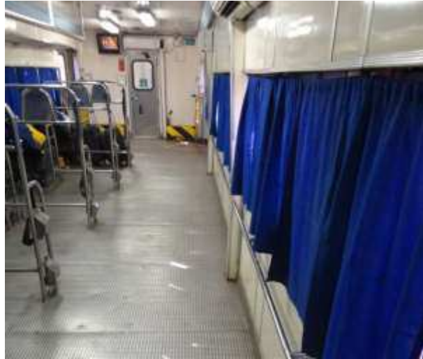
Figura 27 – Barras de apoio no corredor do carro P.C.D
