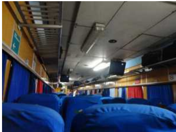
Figura 23 – Revestimentos internos de paredes e forro do carro executivo
