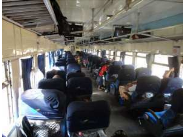
Figura 61 – Revestimentos das paredes e forro do carro econômico tipologia 2
