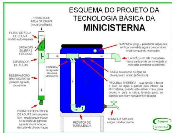
Figura 62 – Esquema em corte do funcionamento estrutural da minicisterna.
