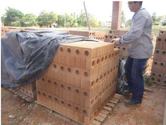
Figura 44 – Tijolos na fase de secagem, sobre as paletes. Fonte: A autora, 2012.
