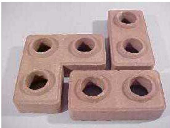
Figura 16 – Tipos de tijolos de solo-cimento usados no protótipo da Casa Ecológica di IVIG. Fonte: STILPEN, 2007.
