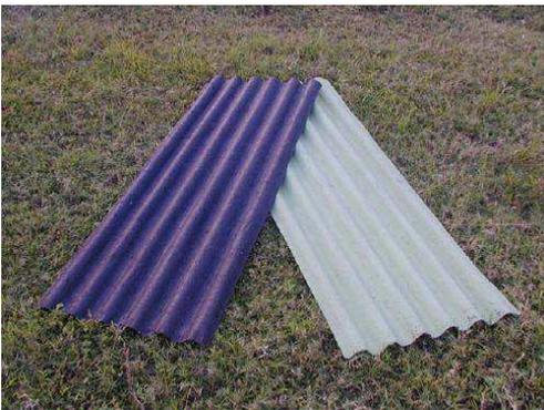
Figura 21 – Telha de fibra de coco produzida no IVIG. Fonte: STILPEN, 2007.
