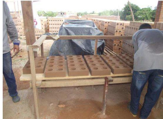
Figura 43 – Fase de pré-secagem dos tijolos pós-prensa. Fonte: A autora, 2012.
