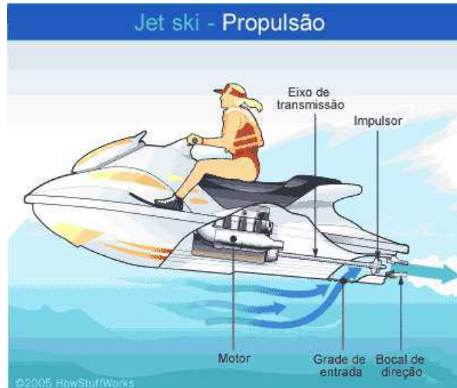
Figura 7 - Motor e mecanismo a jato de um jet ski. Fonte: Howstuffworks. 2011
