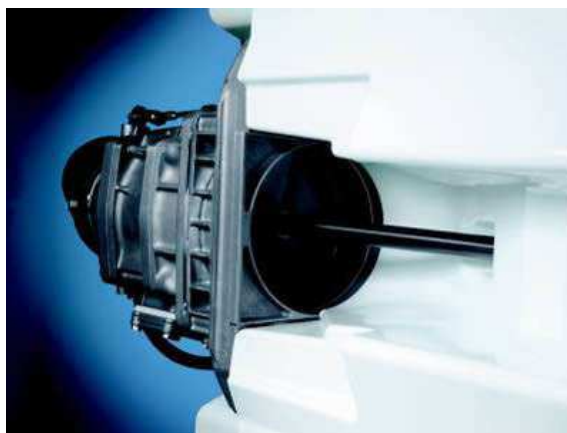
Figura 8 - Impulsor e direção de saída FX da Yamaha. Fonte: Foto cedida por Yamaha Motor Corporation, U.S.A.
