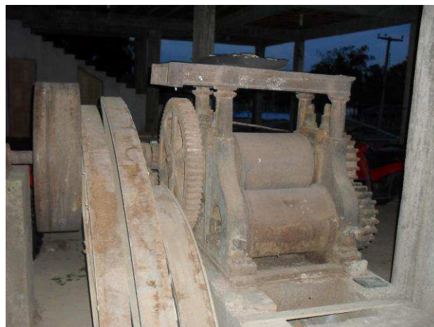
Foto 3 e 4 – Tachos e moenda que eram usados na fabricação de açúcar- Fazenda Nazaré.
