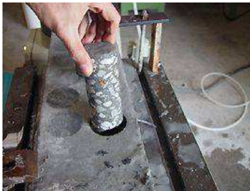
Figura 3.1 Amostra de teste para um concreto mais compacto, com baixo custo e ecologicamente correto. FONTE: APDC, 2011.
