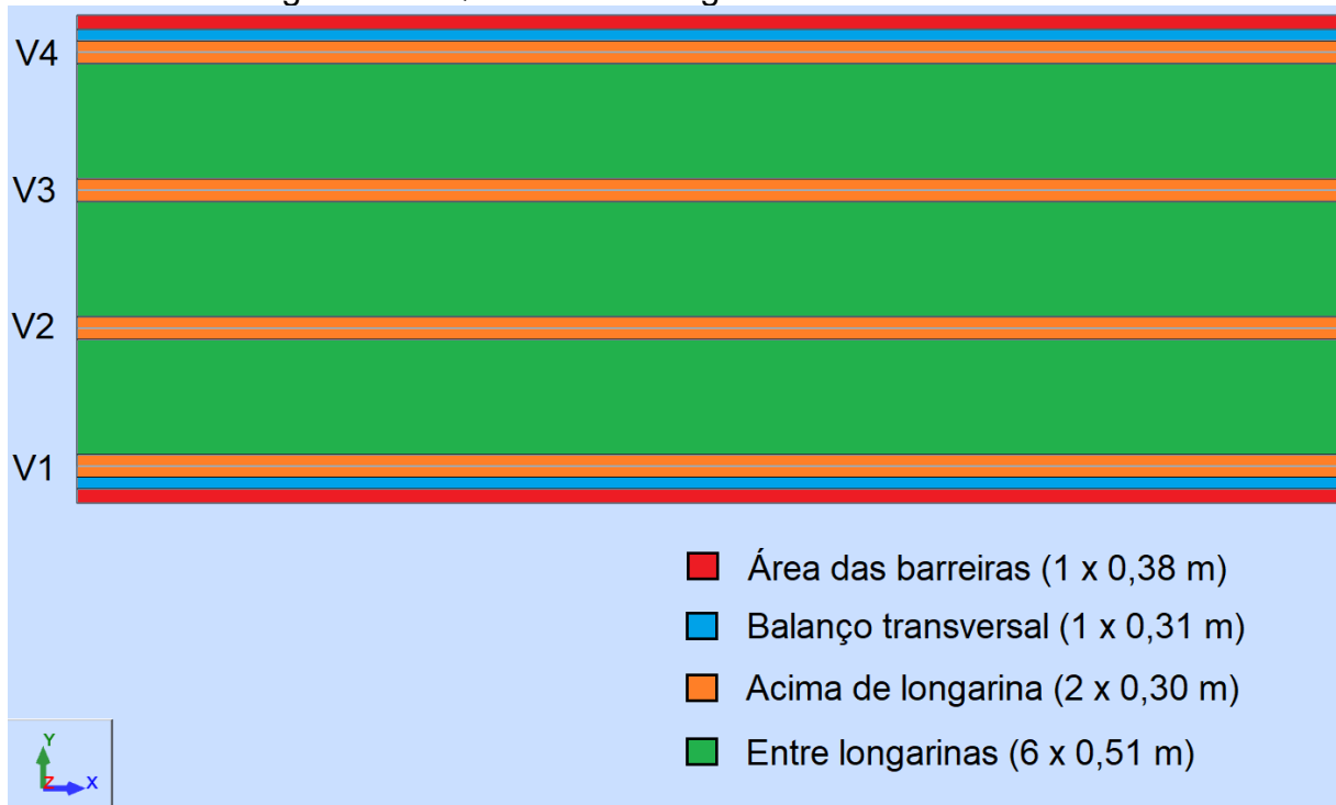
Figura 76 – Quantidade e largura de elementos finitos
