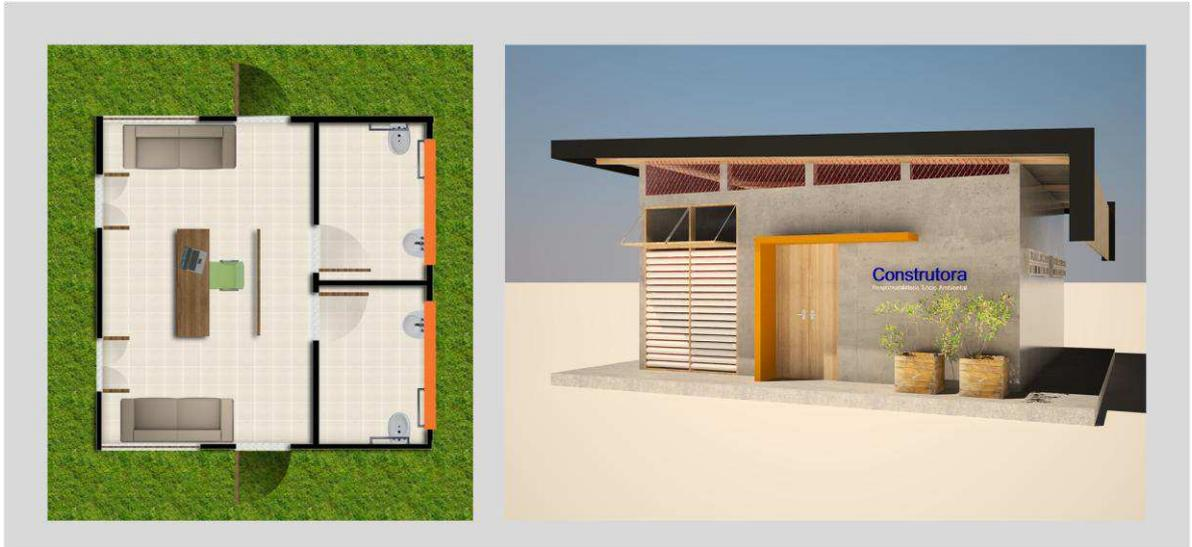
Ilustração 30: Módulo 36m<sup>2</sup>. Laboratório de Informática e Banheiros.
