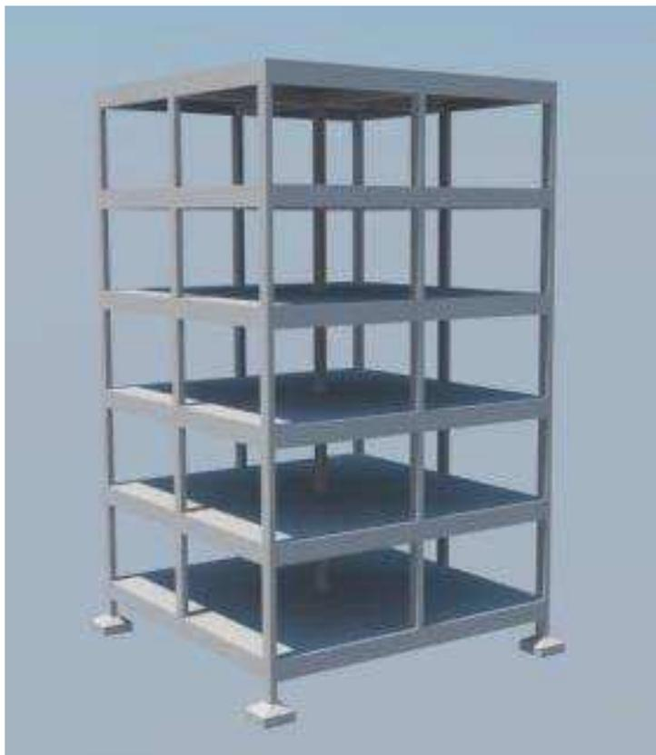
Imagem 16: Continuidade dos pilares da estrutura
