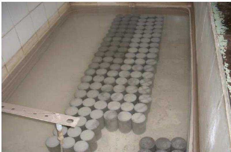
Foto 27: Cura submersa dos corpos-de-prova
