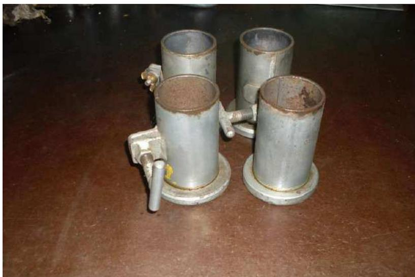
Foto 26: Moldes usados para os corpos-de-prova
