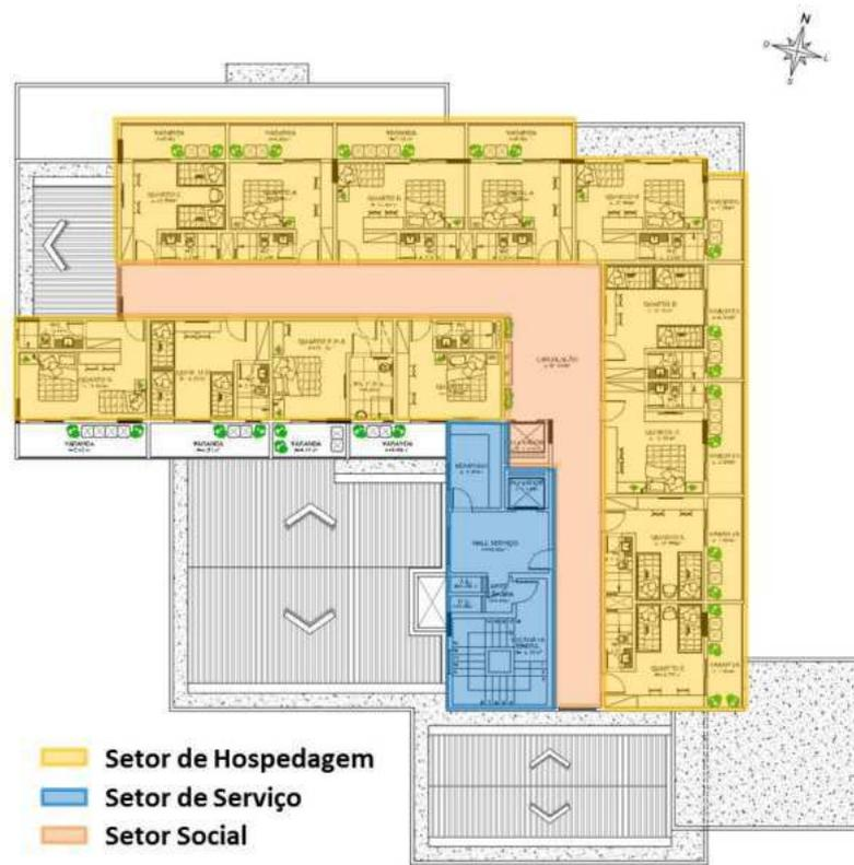
Figura 50 – Setorização do pavimento tipo
