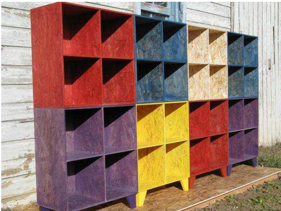
Figura 09 – Demonstração de reaproveitamento de tapumes de OSB remanescentes.
