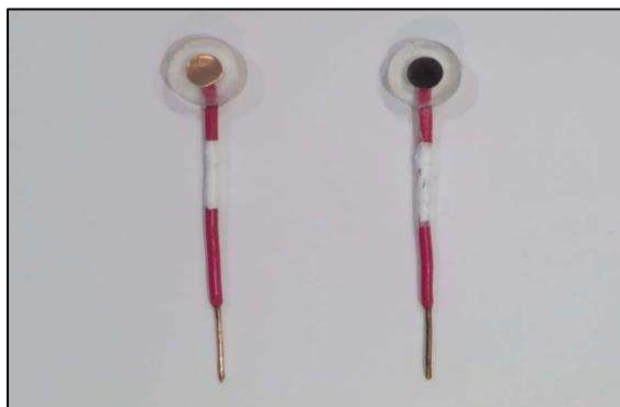
FIGURA 10 – Eletrodo de cobre e eletrodo de cobre revestido com Ni eletrodepositado.
