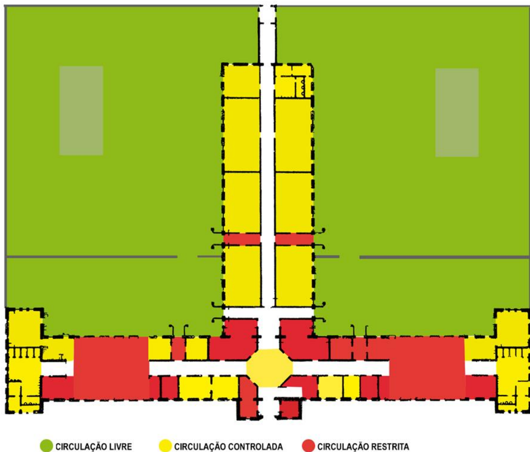
Figura 12 – Estudo de dinâmica de fluxos do Hospital de custódia e tratamento psiquiátrico Professor André Teixeira Lima
