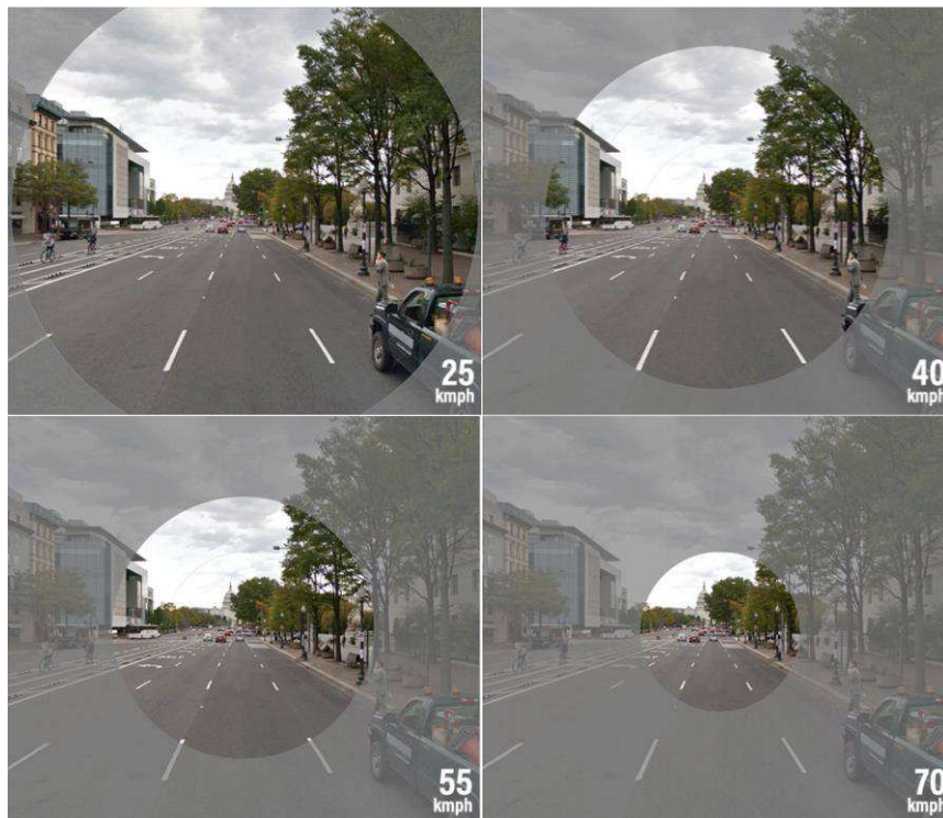
Figura 5: Comparativo da percepção da rua na visão periférica em função da velocidade de deslocamento
