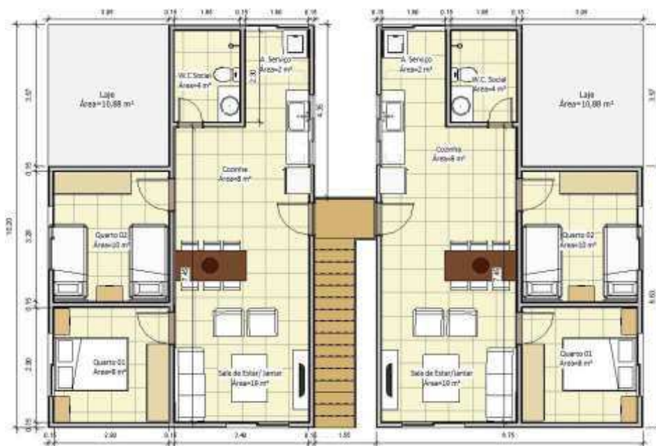
Figura 32 - Planta de layout – 1 pavimento casa sobreposta
