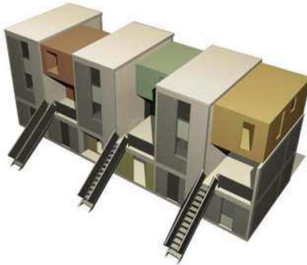
Figura 12 - Esquema da edificação com as expansões – Quinta Monroy
