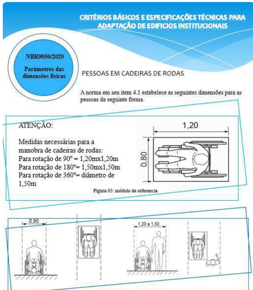
Figura 06: Item 4.3.1 da norma figura 4 mostra a referencia de dimensões para deslocamento de cadeira em linha reta
