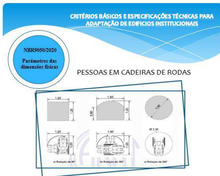
Figura 03: Áreas para manobras de cadeiras de rodas sem deslocamento - NBR9050
