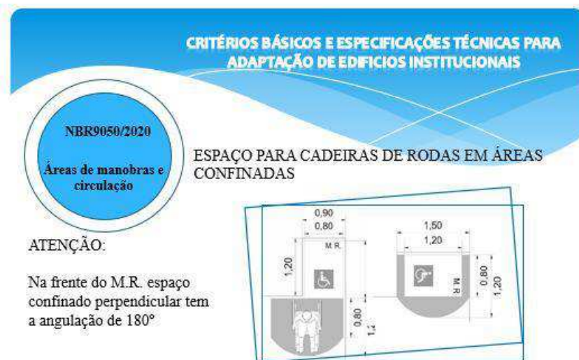
Figura 07: Item 4.3.6 espaço para cadeira de rodas em área confinado
