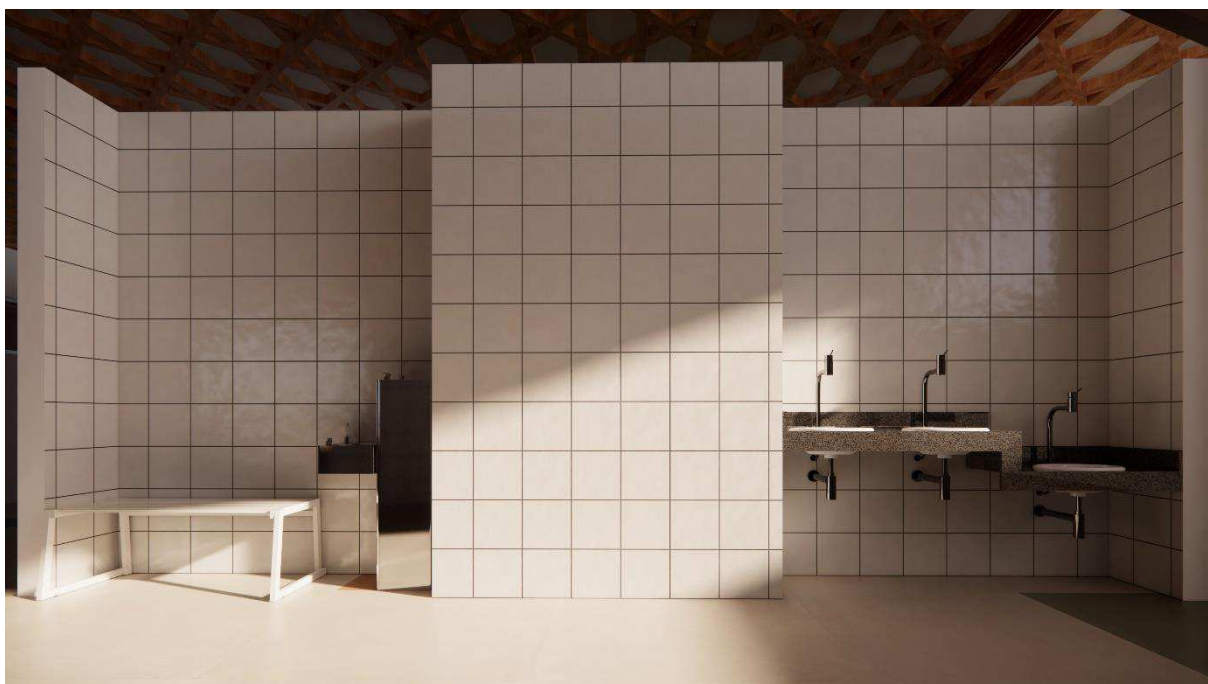
Figura 95. Bebedouro e pia acessíveis.
