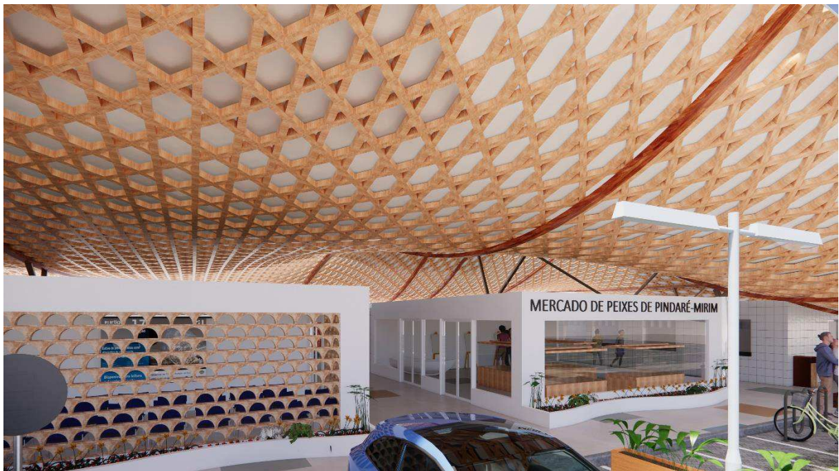
Figura 75. Estrutura de madeira da cobertura.
