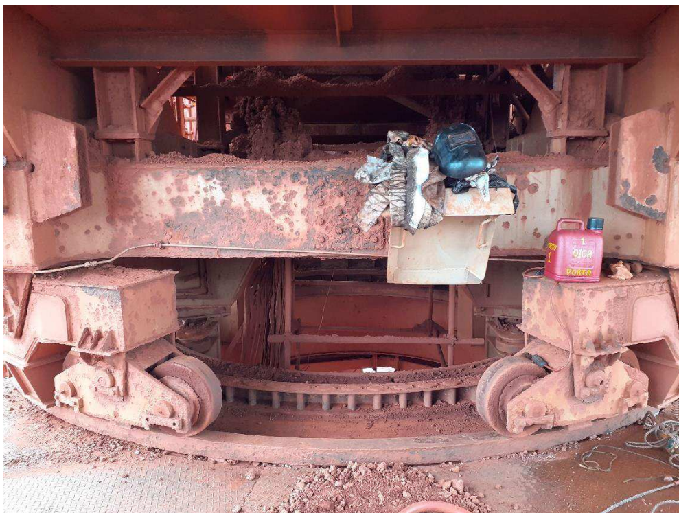
Figura 4.6 - Sistema de giro do Stacker (Autora, 2021)
