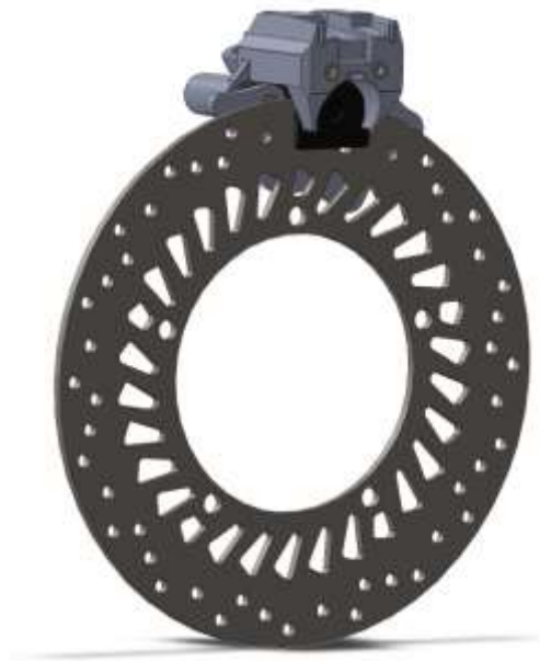
Figura 5.5 – Montagem disco e pinça (Autor, 2021).
