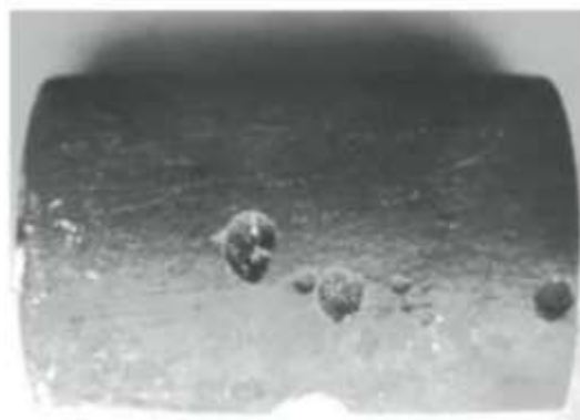
Figura 2.5: Corrosão Alveolar (GENTIL, 2011)
