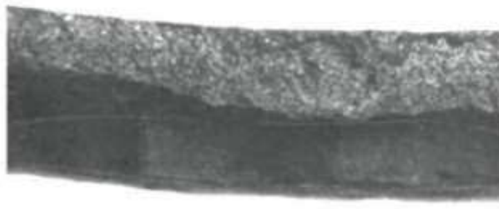
Figura 2.11: Ferro Fundido que sofreu corrosão grafítica (GENTIL, 2011)
