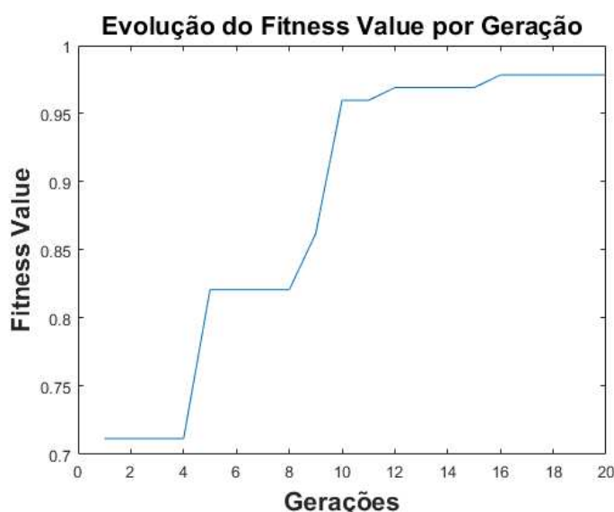
Figura 32 - Curva de evolução do algoritmo genético demonstrando a otimização do resultado pelas gerações.
