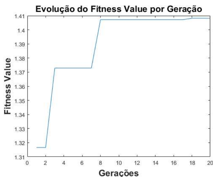
Figura 21 - Curva de evolução do algoritmo genético demonstrando a otimização do resultado pelas gerações.
