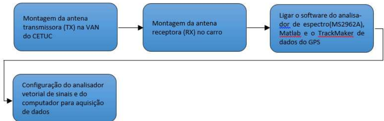
Figura 35: Etapa de Montagem do set-up de Medição em Campo.
