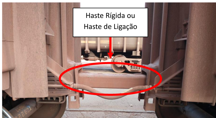
Figura 4.16 – Haste Rígida formando uma dupla de vagões germinada (Autor, 2021).
