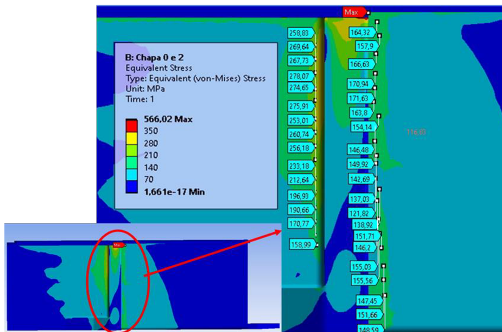
Figura 6.10 – Análise interna da extremidade da viga para o Caso 3 (Autor, 2021).
