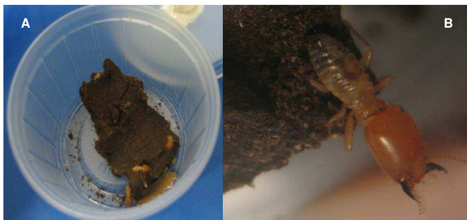
Figura 1. (A) Recipiente com o material cartonado, disco de papelão e Cornitermes cumulans ( 25 \pm 2^{\circ}\text{C} ; 70 \pm 10\% U.R. e escotofase contínua). (B) soldado de Cornitermes cumulans sobre o material cartonado. São Luis (MA), 2008.
