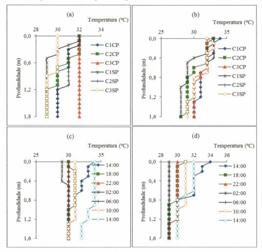
Figura 9 — Estrutura térmica na água das cavas, mensuradas entre 10h e 14h: (a) dia 01/10/2003; (b) dia 30/11/2003. Evolução diária da temperatura da água das cavas: (c) C1CP e (d) C3SP.
