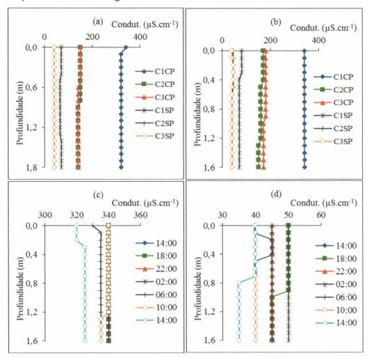
Figura 10 - Perfís de condutividade elétrica na água das cavas: (a) dia 01/10/2003 e (b) dia 30/11/2003. Evolução diária da condutividade elétrica da água das cavas: (c) C1CP e (d) C3SP.
