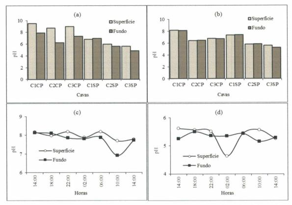
Figura 11 - Variação do pH da água das cavas mensuradas: (a) dia 01/10/2003; (b) dia 30/11/2003. Evolução diária do pH da água das cavas: (c) C1CP e (d) C3SP.
