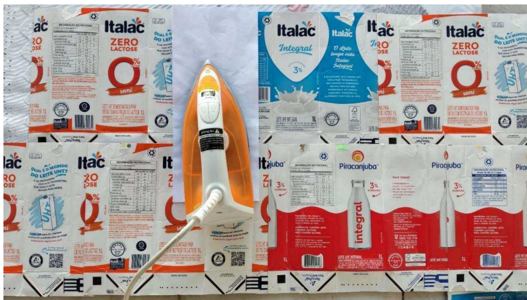
Figura 16: Colagem das embalagens com o ferro de passar.
