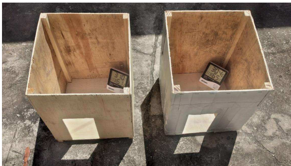
Figura 12: Aparelhos de medição de temperatura posicionados nos protótipos.
