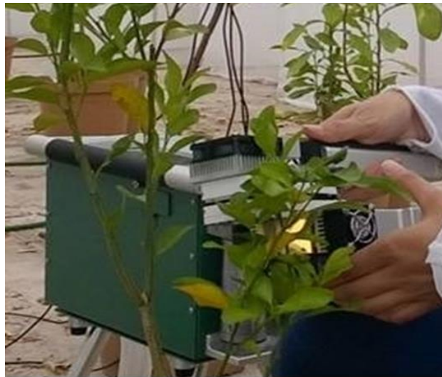
Figura 3. Sistema portátil de medição das trocas gasosas IRGA, modelo LI-6400 em variedades de citros em casa de vegetação. São Luís, MA, 2015.
