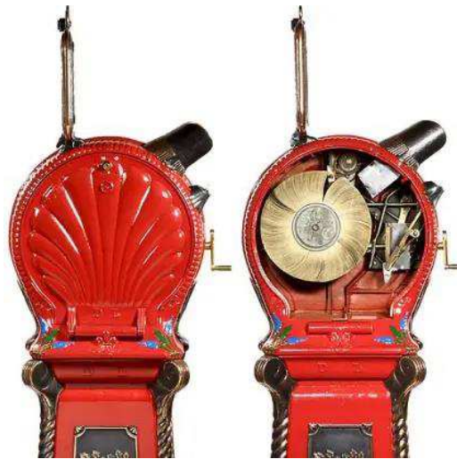
Figura 12 - Mutoscópio (fechado e aberto)
