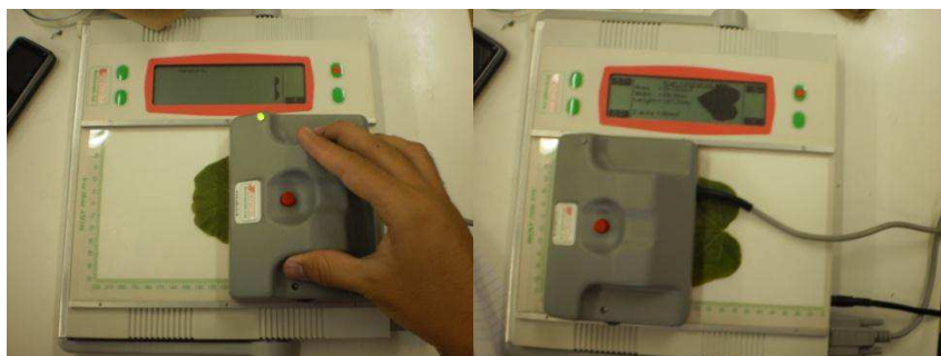
Figura 3: Medidor de Área Portátil Laser, AM 300, ADC, utilizado para mensuração da área foliar de Jatropha curcas L.
