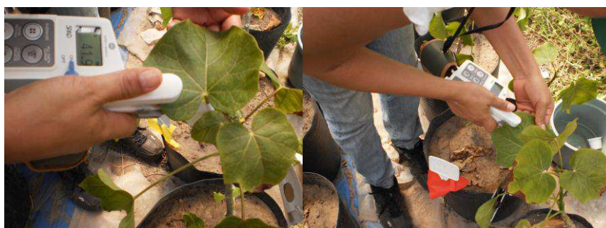
Figura 5: Medidor portátil de clorofila SPAD-502 (Minolta, Japão), utilizado em folhas de Jatropha curcas L., no município de São Luís - MA.
