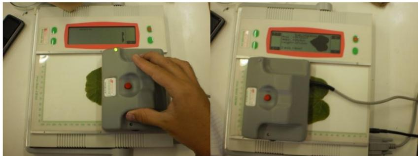
Figura 3: Medidor de Área Portátil Laser, AM 300, ADC, utilizado para mensuração da área foliar de *Jatropha curcas* L.
