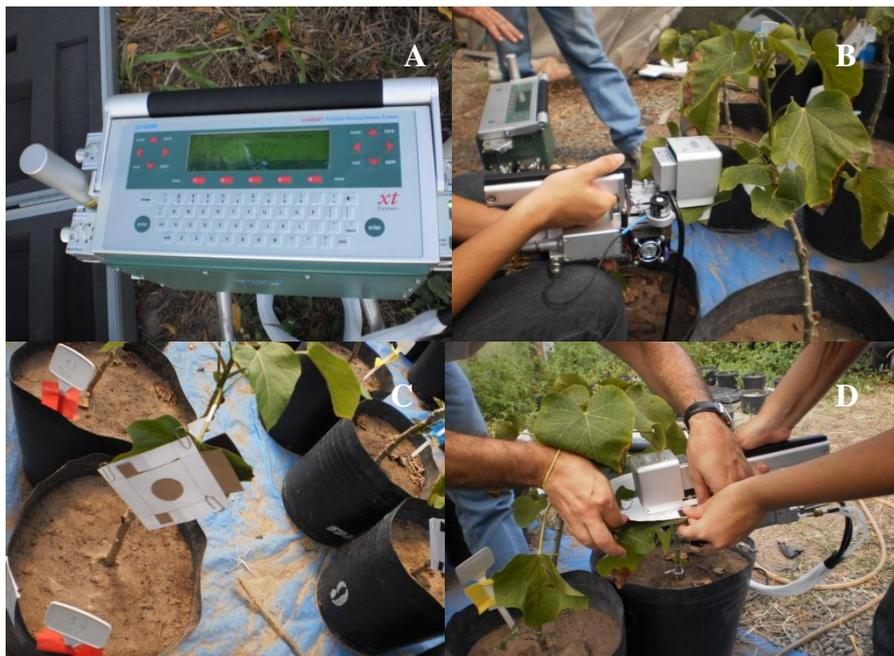
Figura 4: Medições da fluorescência da clorofila a por meio do Analisador portátil de CO<sub>2</sub> no infravermelho (A e B), e adaptação ao escuro por 30 minutos por meio de pinças (C e D), em folhas de *Jatropha curcas* L., no município de São Luís - MA.
