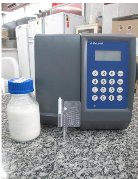
Equipamento contador eletrônico de células somáticas DeLaval® e seu acessório cassete (à direita); frasco contendo amostra de 250 mL de leite (à esquerda).
