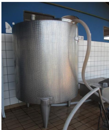
Tanque de estocagem com capacidade para 10.000 litros de um dos laticínios da microrregião de Imperatriz, MA.
