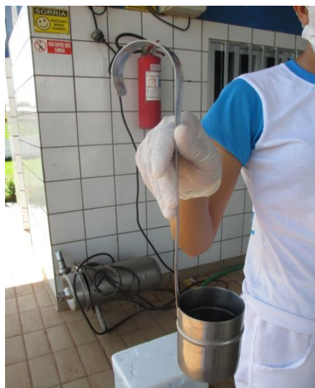
Coletor de inox utilizado para coletar as amostras nos tanques de estocagem.
