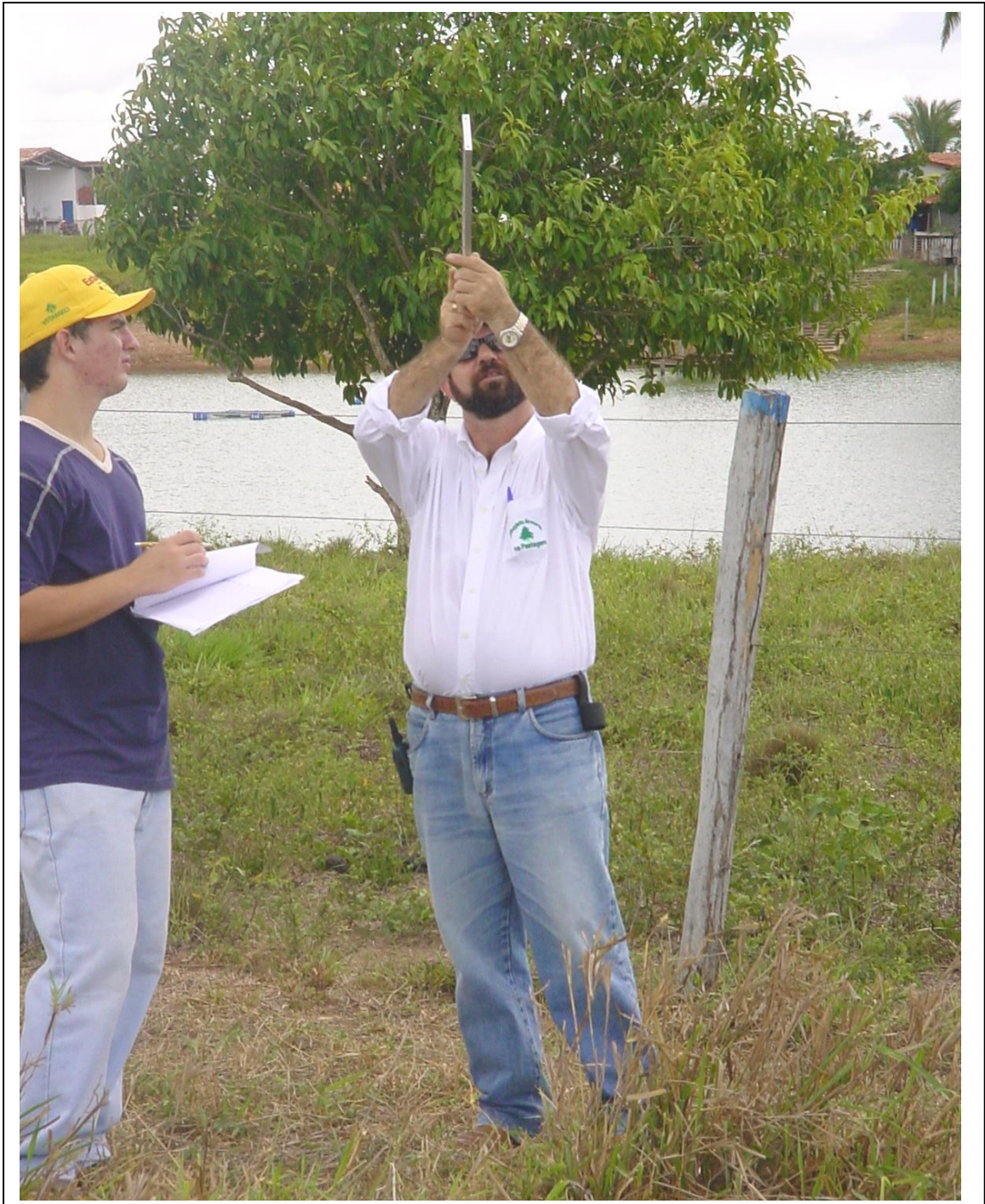
Apêndice 3. Equipe realizando a medida de altura das árvores com o uso da prancheta dedométrica.
