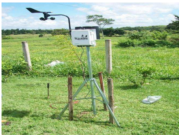
Figura 5. Mini-estação climatológica WatchDog modelo 2900ET instalada na área experimental de abril a outubro de 2013.
