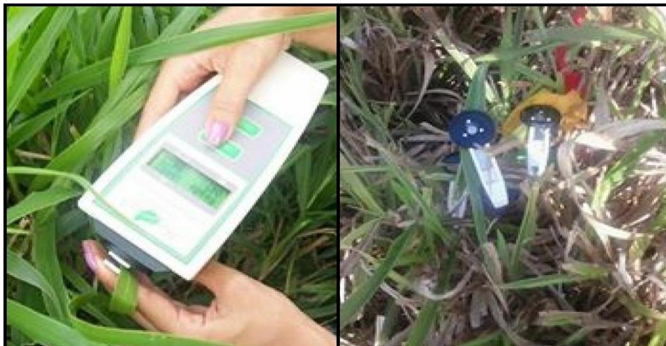
Figura 7. Medições com o Fluorômetro em folhas de capim braquiária, época chuvosa (A) e época seca (B).
