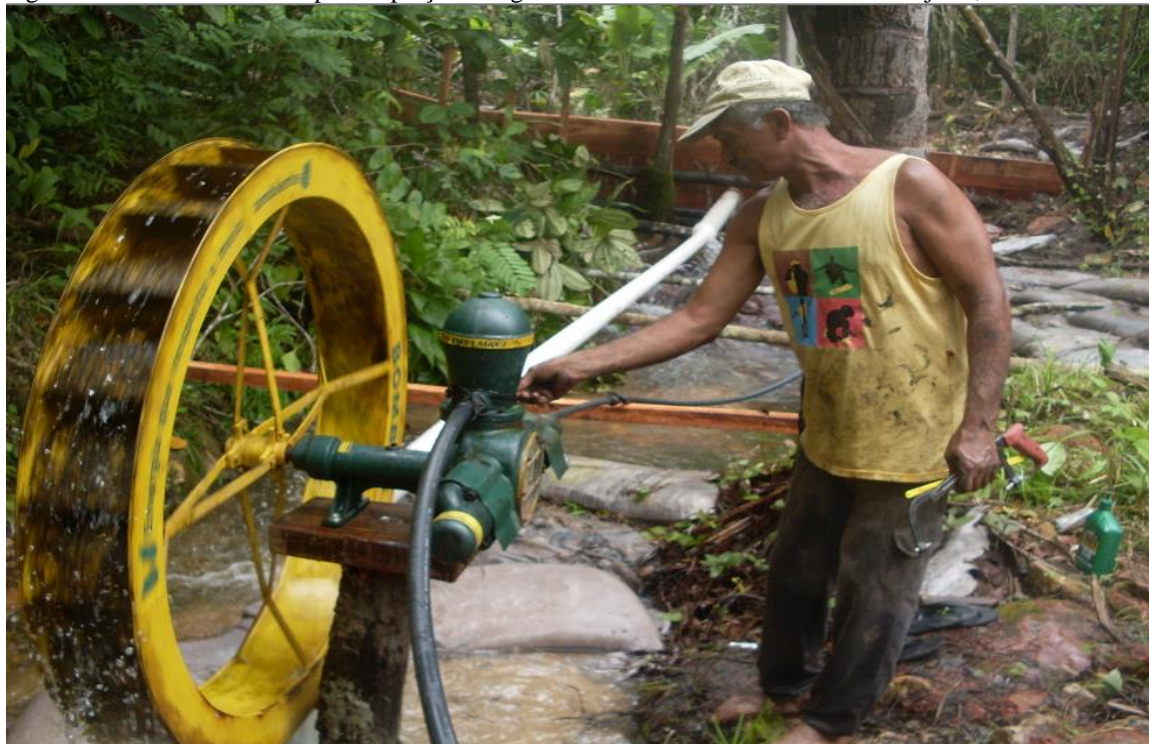
Figura 42- Sistema artesanal para captação de água no encontro dos riachos Isebe e Lajeiro, em Solta
