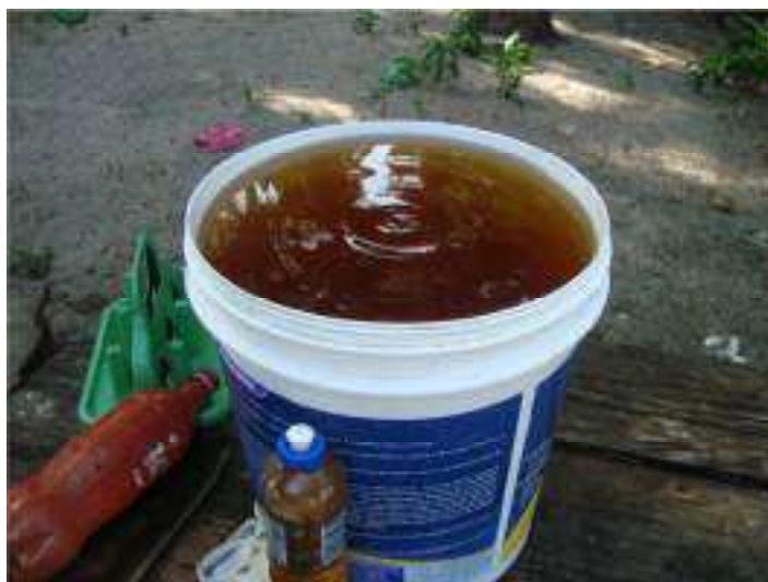
Figura 21 – Água avermelhada coletada da bomba manual
