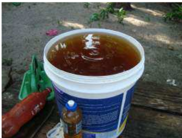
Figura 21 – Água avermelhada coletada da bomba manual
