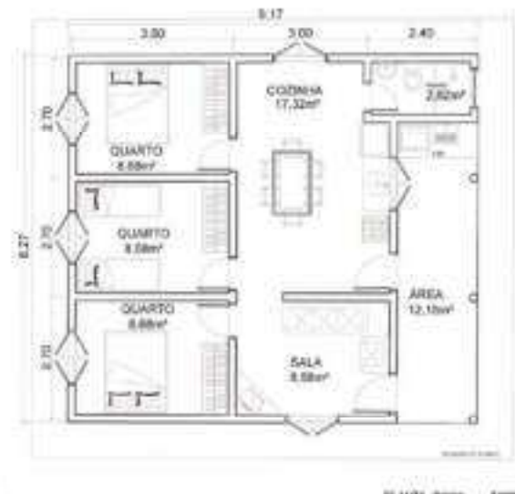
Figura 3 – Tipologia de 3 quartos com banheiro interno. A tipologia de 2 quartos segue a mesma modulação
